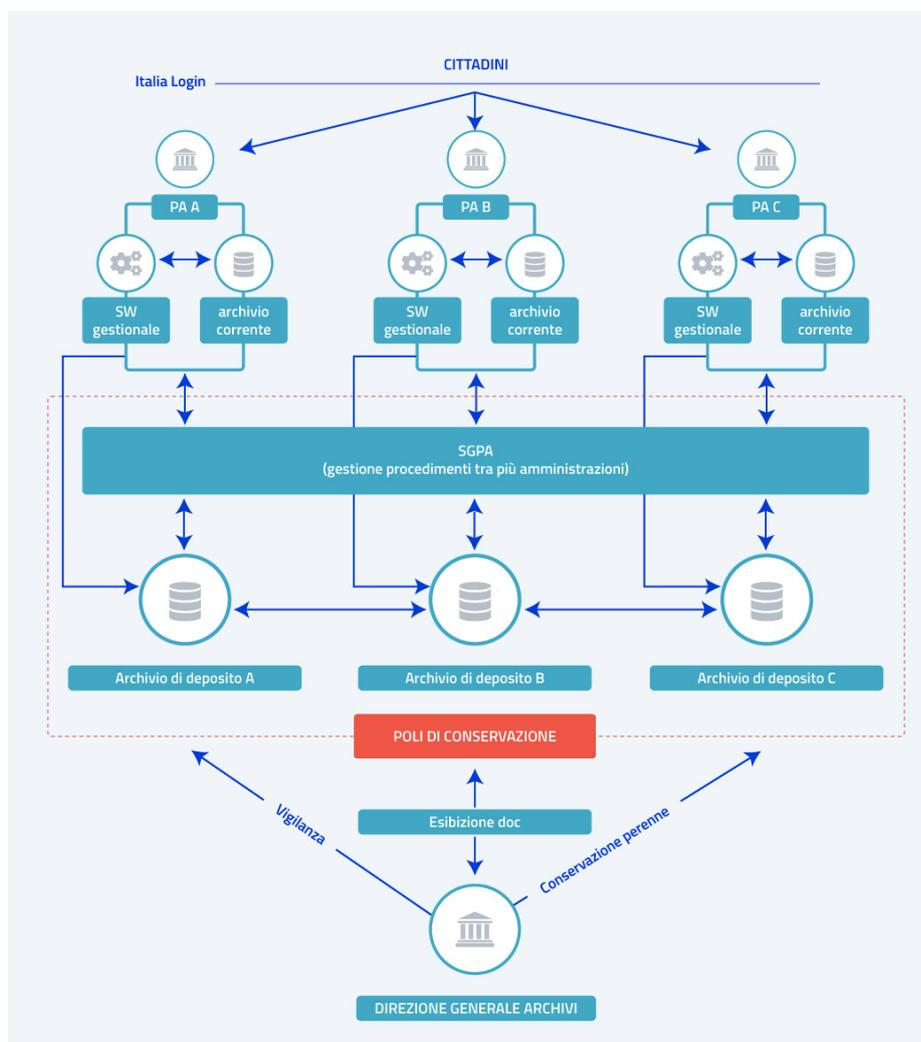
Figura 6.5 - Il sistema di gestione dei procedimenti amministrativi della PA: architettura d'insieme
